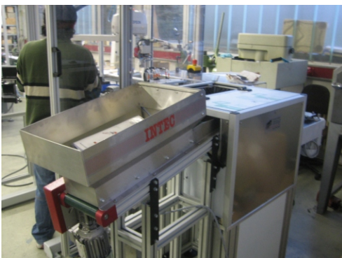
Zuführbunker mit Sortier- und Vereinzelungseinheit
