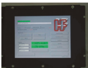
Touch-Screen-Bedienfeld mit Grafikoberfläche
